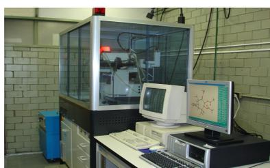
equipo de un difractómetro automático
